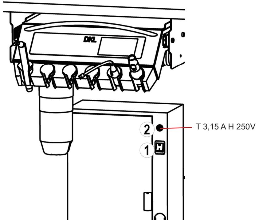
Die Behandlungseinheit verfügt über einen Netzschalter ① an der Stuhlbasis. Der Netzschalter verbindet die Behandlungseinheit mit dem Stromnetz. Bei längeren Standzeiten sollte die Behandlungseinheit vom Stromnetz getrennt werden.
